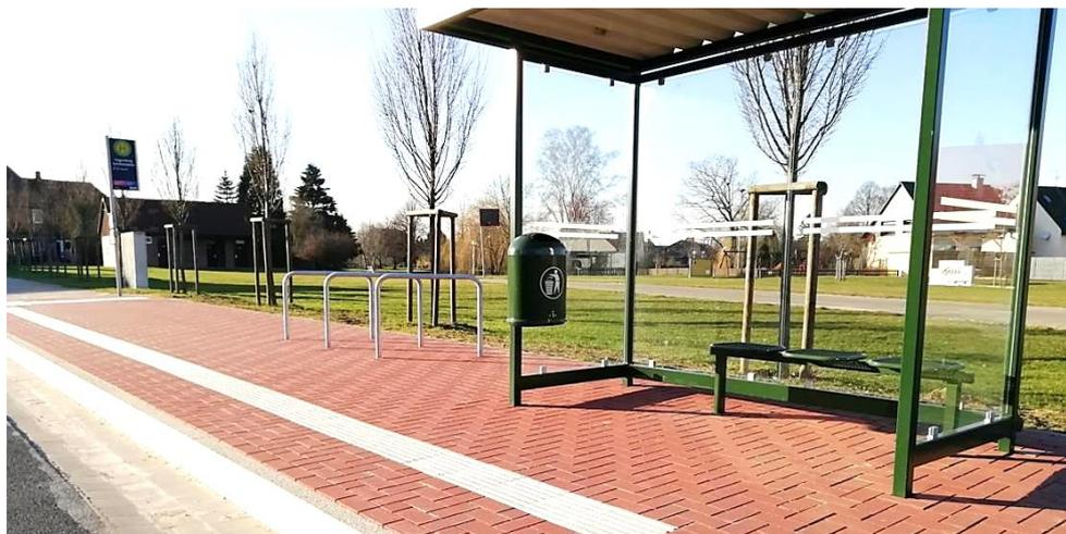
Abb. 51 Beispiel: Barrierefreie Bushaltestelle mit nicht überdachten Fahrradbügeln
